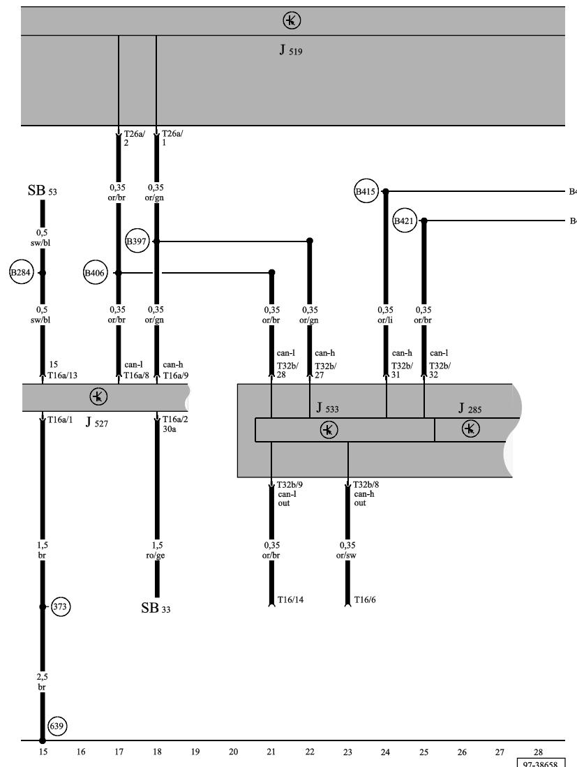
车载电网控制单元、转向柱电子装置控制单元、数据总线诊断接口
